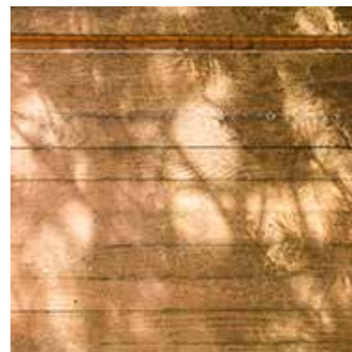
Betonoverflade i rødlige nuancer i Elefanthuset i Zoologisk Have, København. Farven skyldes et tilslag af rødt farvestof (jernoxid) i cementen. Foto: Torben Eskerod.
