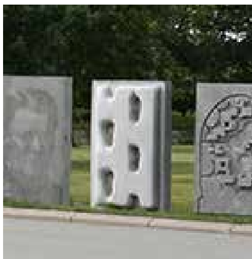
Teknologisk Institut (TI) har udført en række demonstrationsforsøg med relieffer skabt via digital produktion. Mulighederne er som det ses store, men effekterne skal anvendes med betydelig arkitektonisk forsigtighed. Foto: Foto: TJA.
